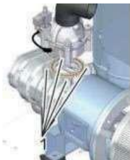
Рис. 30: Крепежные винты регулятора впуска
