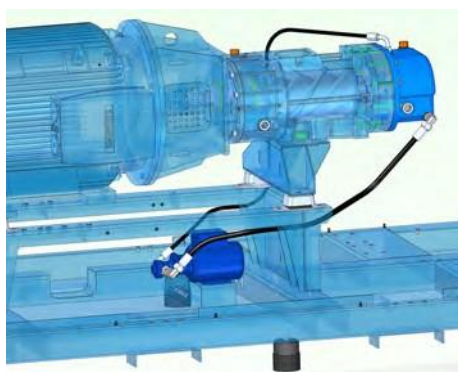
Рис. 16: Насос для смазки редуктора ступени компрессора
