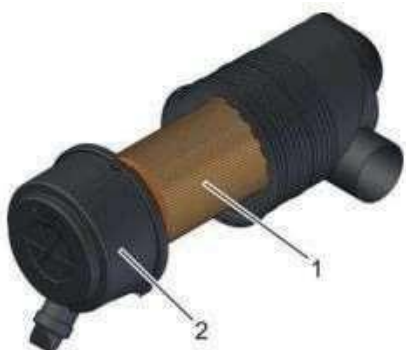
Рис. 37: Разборка корпуса воздушного фильтра
