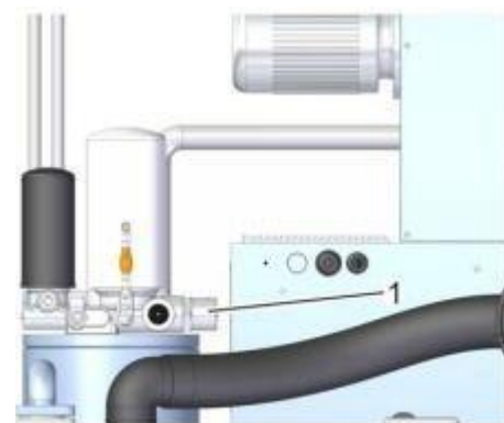
Рис. 11: Клапан минимального давления с функцией обратного клапана
