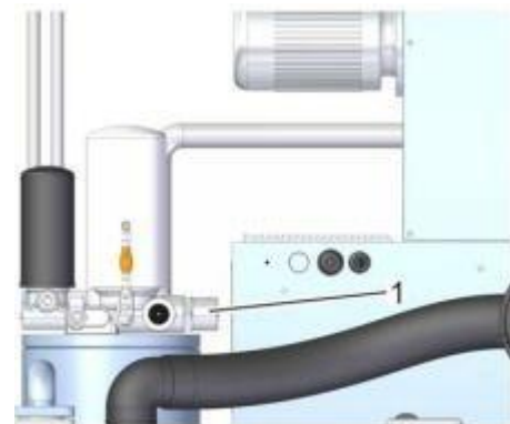
Рис. 11: Клапан минимального давления с функцией обратного клапана
