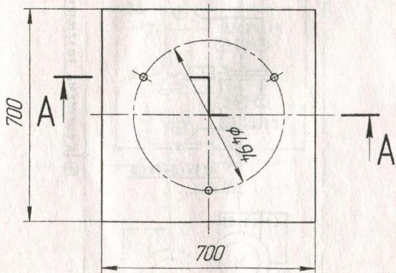
Рис. 13. План расположения фундаментных болтов установки КВ-7
