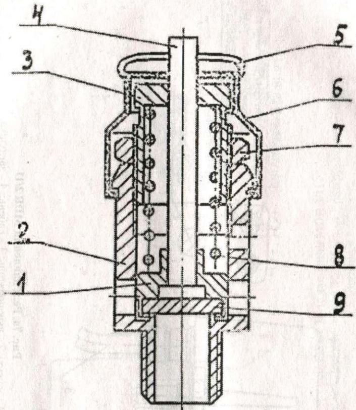
Рис. 8. Клапан предохранительный
